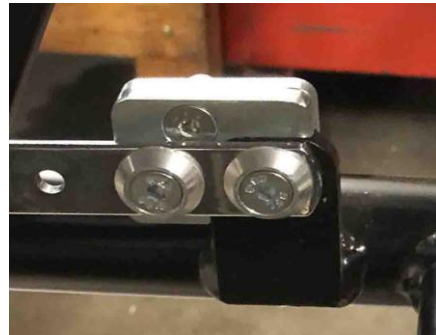
Renfort pour patte de radiateur soudée à un seul trou
